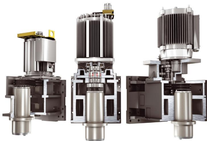
Рисунок 2.7 – Головні приводи (в розрізі): із пасовою передачею, прямим приводом, редуктором
