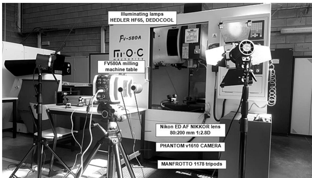
Рисунок 1.12 – Тестування динаміки запуску та гальмування верстатного столу для запису швидкозмінних явищ за допомогою камери машинного зору Phantom v1610
