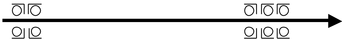
Рисунок 2.11 – Компонувальна схема швидкохідного шпиндельного вузла
