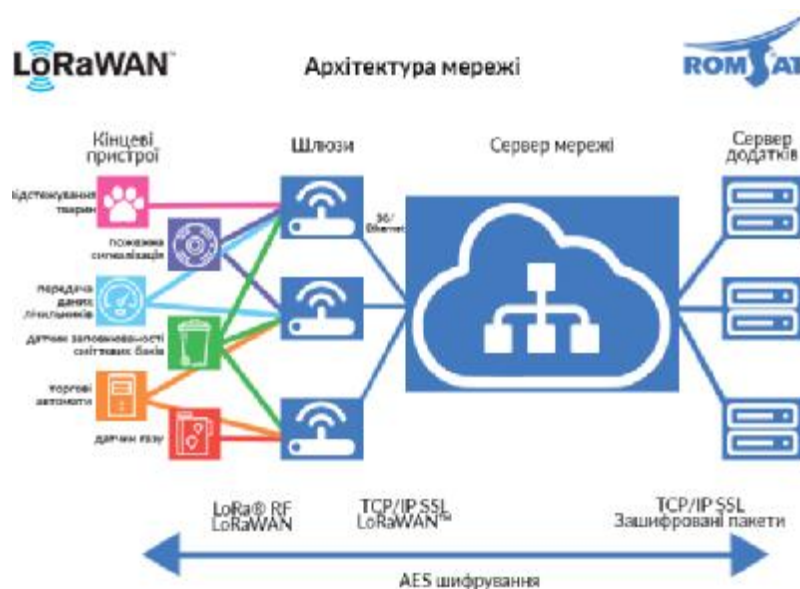
Рис. 2.3. Архітектура та область застосування протоколу LoRaWAN
