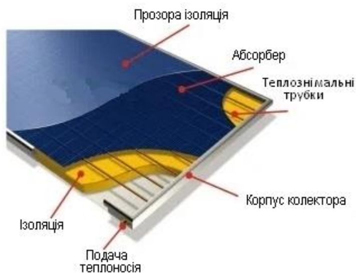
Рис. 1.3. Конструкція плоского сонячного колектора
