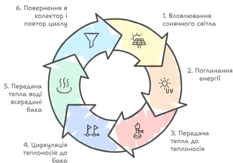
Рис. 1.1. Принцип роботи сонячного колектора
