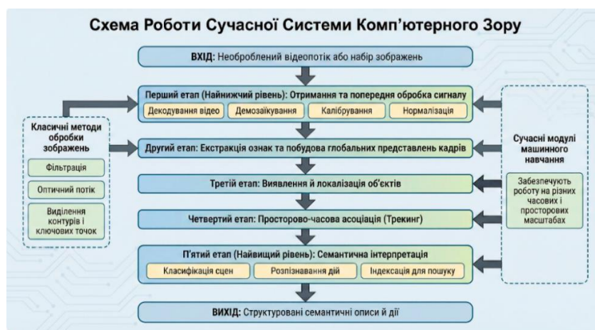
Рис. 1.3. Схема роботи системи CV
