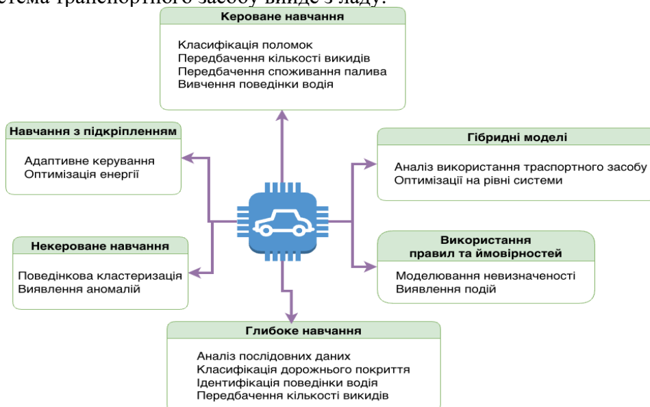
Рисунок 1. Методи машинного навчання для завчасного передбачення несправностей транспортного засобу на основі OBD-2 даних
