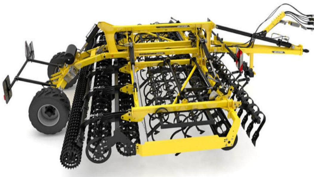
Рисунок 1.6 – Культиватор BEDNAR SWIFTER SO_PROFI [5]
