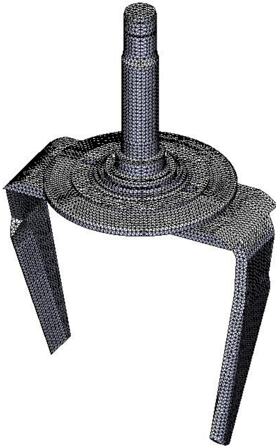
Рисунок 2.19 – Сітка кінцевих елементів на 3d моделі робочих органів
