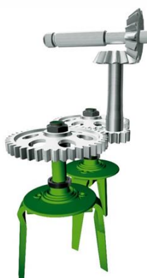
Рисунок 2.4 – Схема передачі крутного моменту від ВВП
