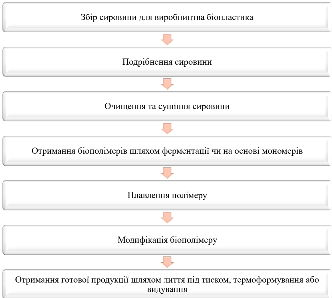
Рисунок 3.3 – Основні етапи виробництва біорозкладного пластику
