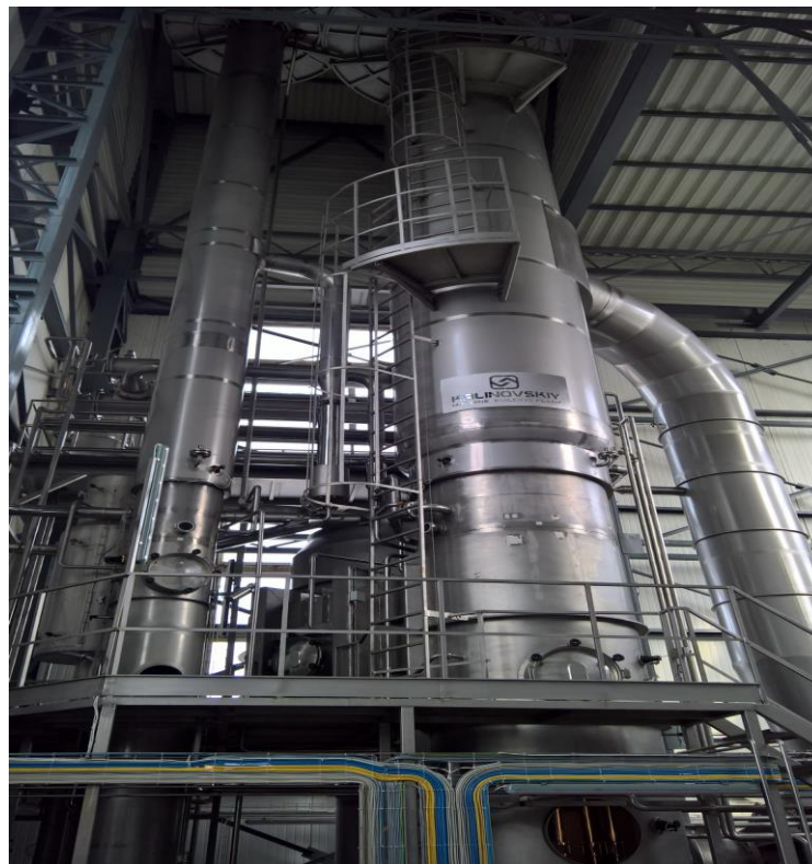
Рисунок 3.2 - Вакуум-випарна установка, пропонована для виробництва сироваткового пермеату
