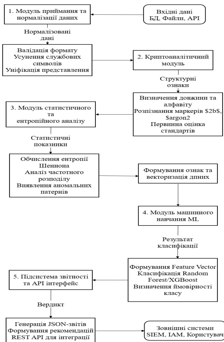
Рис 3.1. Структурна схема архітектури системи
