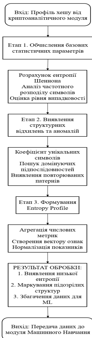
Рис 3.3. Алгоритм роботи модуля ентропійного аналізу
