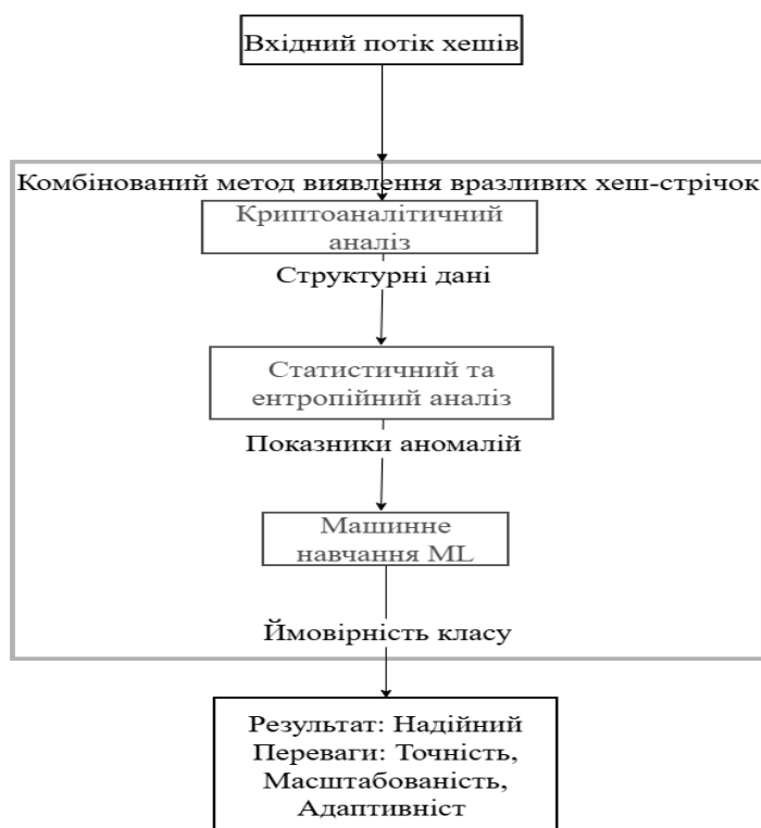
Рис 2.5. Схема роботи комбінованого методу виявлення вразливих хешів
