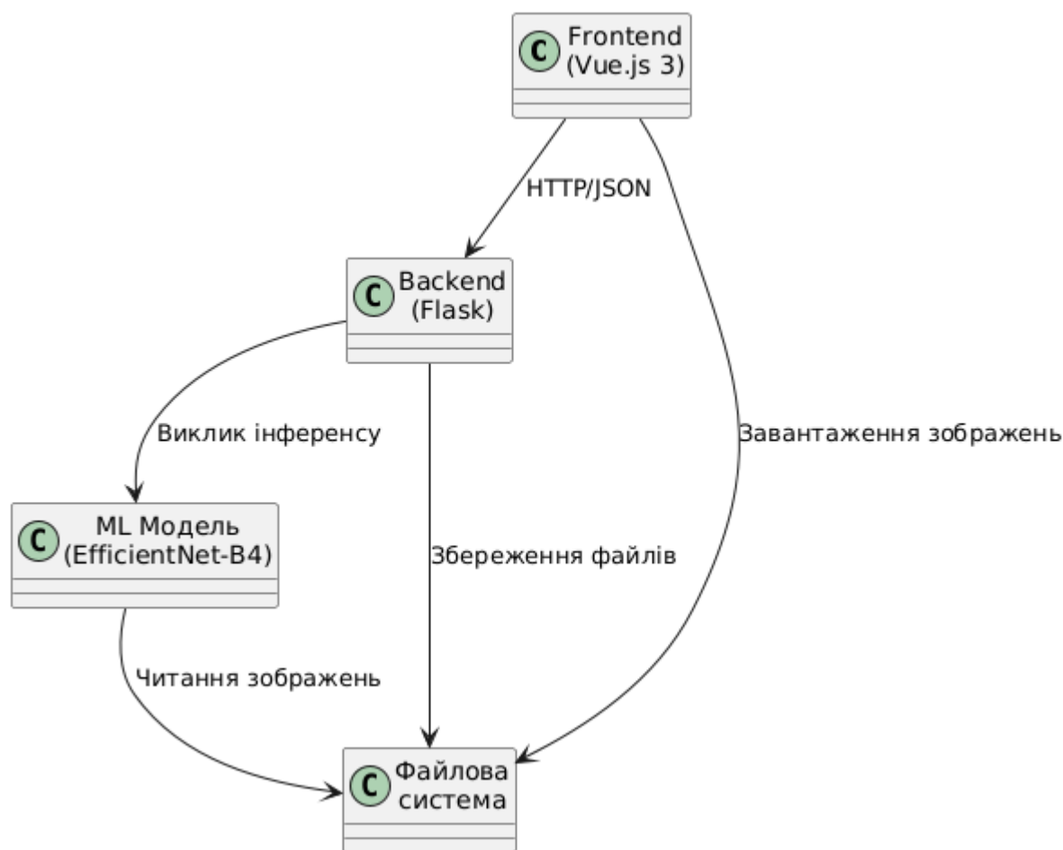
Рис. 3.1. Діаграма компонентів веб-сервісу
