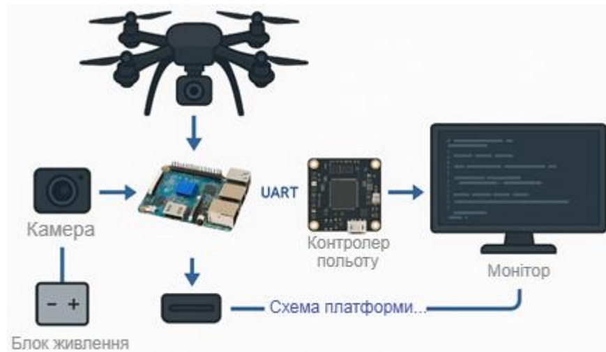
Рис. 3.4. Структурна схема експериментального стану для дослідження системи машинного зору на базі Orange Pi
