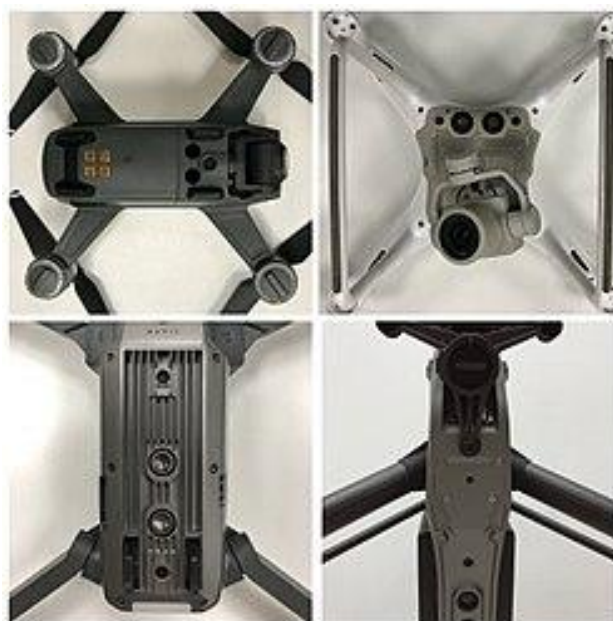
Рис. 1.3. Візуально-інерційна одометрія Visual Inertial Odometry
