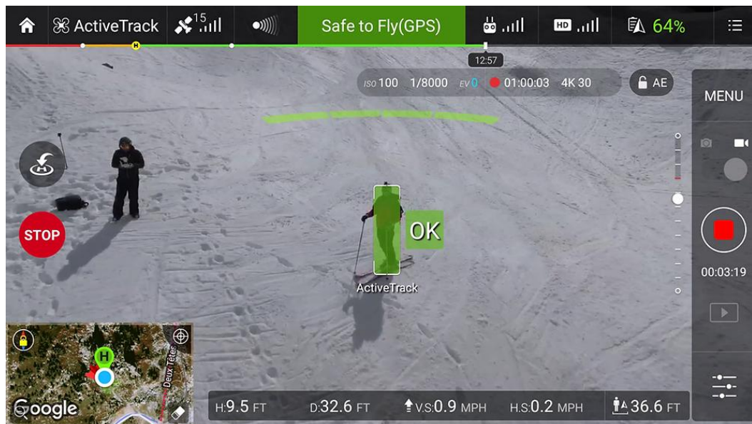
Рис. 1.1. Система ActiveTrack (відстеження об'єкта та прогнозування руху)
