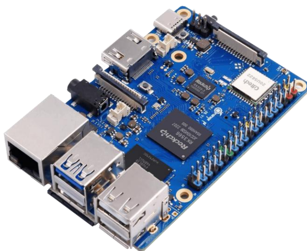
Рис. 3.1. Orange pi 3b v2.1
