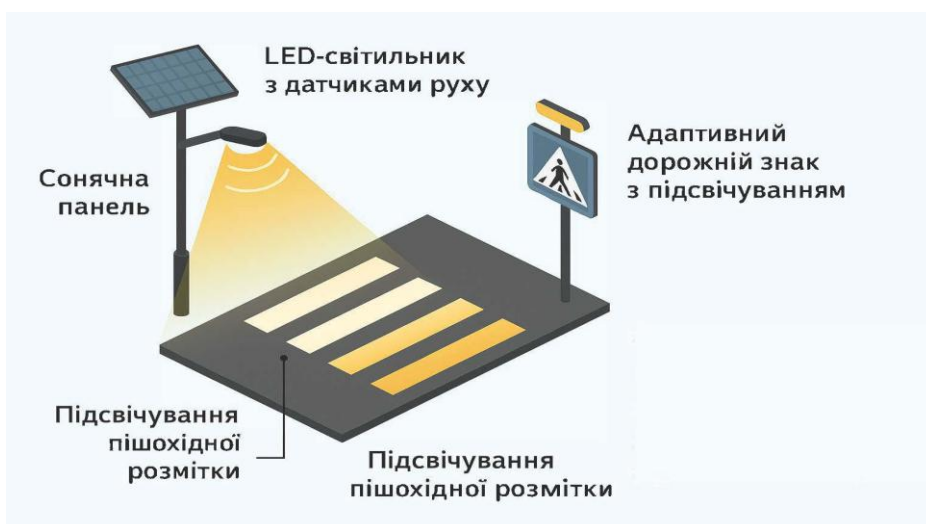
Рисунок 3.6 – Схема освітлення пішохідного переходу з автономною системою освітлення
