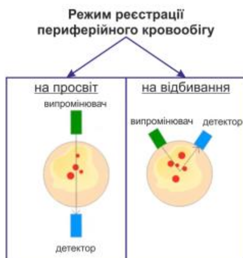
Рис. 2.10. Режими роботи датчиків для відбору фотоплетизмограми: на просвіт; на відбивання [1]
