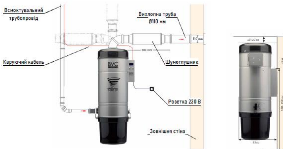
Рисунок 3.35 - Схема монтажу пороходуягу та підключення до трубопроводів
