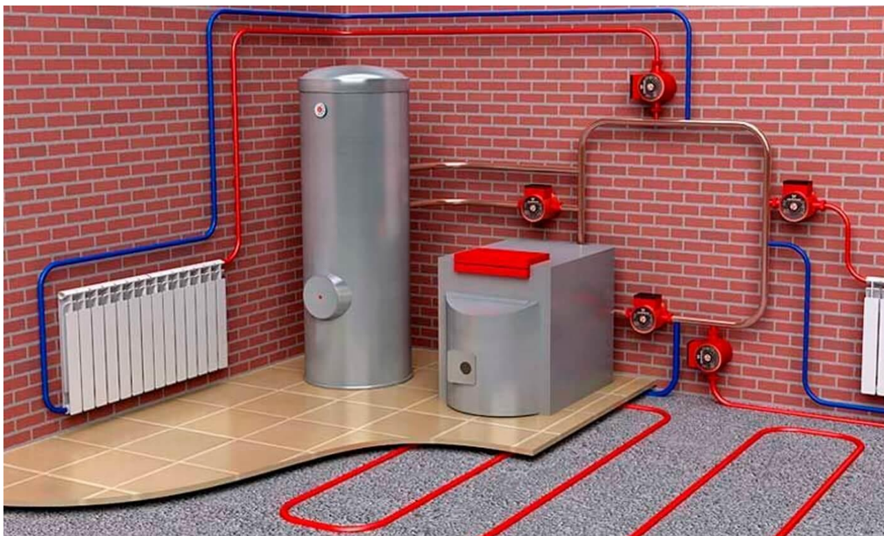
Рисунок 1.1 - Монтаж системи опалення в приватному будинку.
