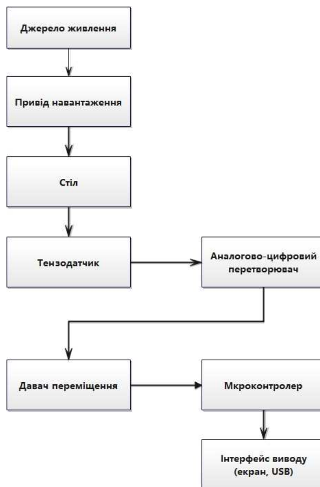
Рисунок 3 – Структурна схема автоматизованої системи тестування пружин
