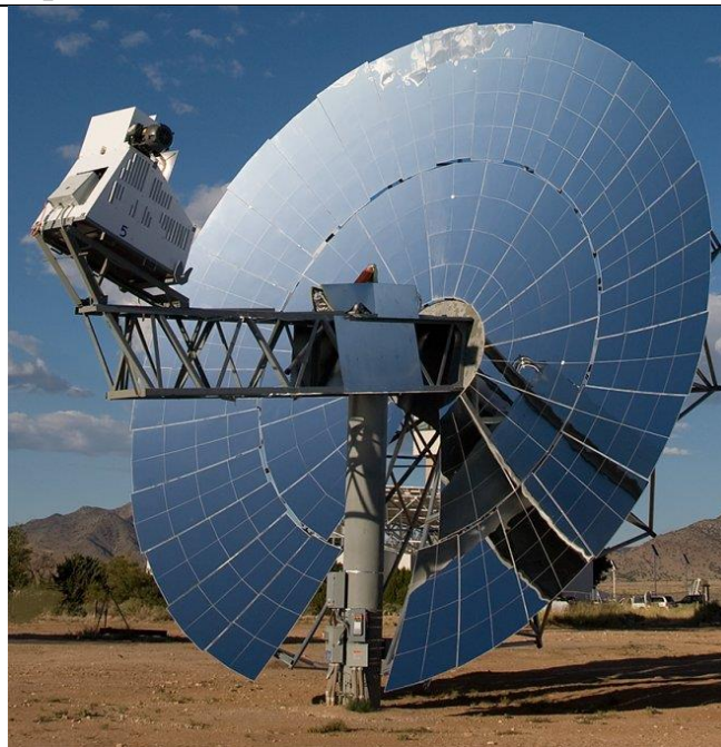
Рисунок 1.5 - Застосування двохосьової системи стеження за Сонцем для сонячної теплової тарілки
