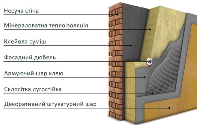
Рисунок 2.4 - Технологія покращення теплоізоляційних властивостей стін кам'яною ватою
