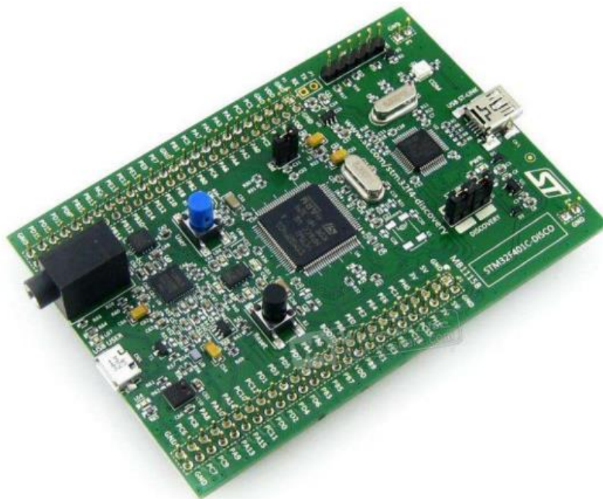
Рис. 3.9. Зовнішній вигляд налагоджувального модуля STM32F401C–DISCO
