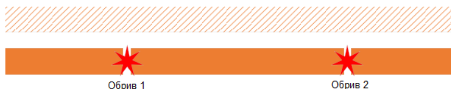
Рис. 1.7. Ціла жила та жила з двома обривами
