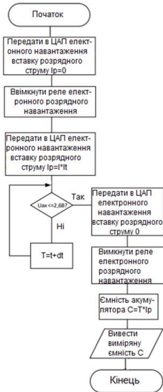
Рис. 3.5. Блок-схема алгоритму вимірювання ємності акумулятора за короткого режиму розряду
