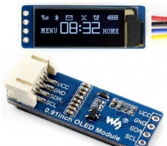
Рис. 2.16. Зовнішній вигляд дисплея Waveshare Electronics 14657 з лицьової та зворотної сторони
