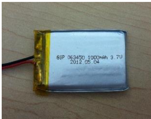
Рис. 1.4. Зовнішній вигляд однієї комірки Li-Pol акумулятора
