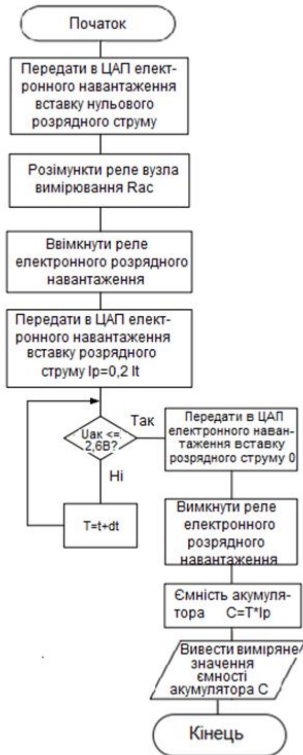
Рис. 3.2. Блок-схема алгоритму дій щодо вимірювання ємності аккумулятора
