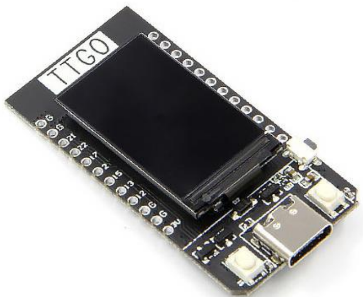
Рис. 3.2. Wi-Fi модуль TTGO ESP-32
