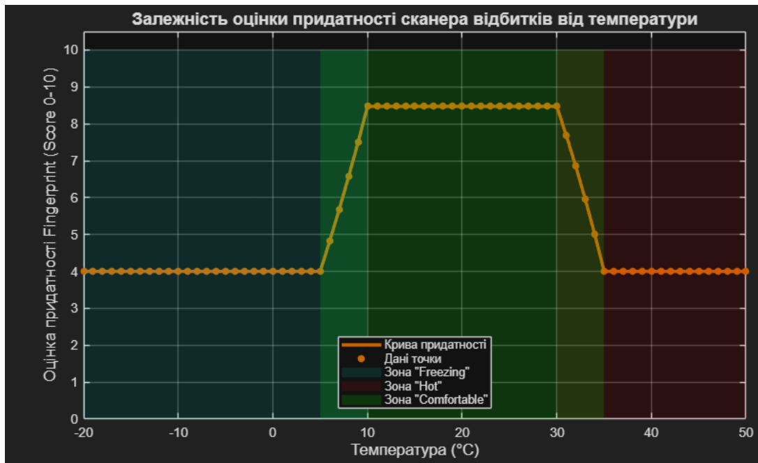
Рис. 3.12. Залежність оцінки придатності сканера відбитків від температури
