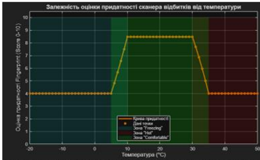
Рисунок 2. Залежність оцінки придатності сканера відбитків від температури
