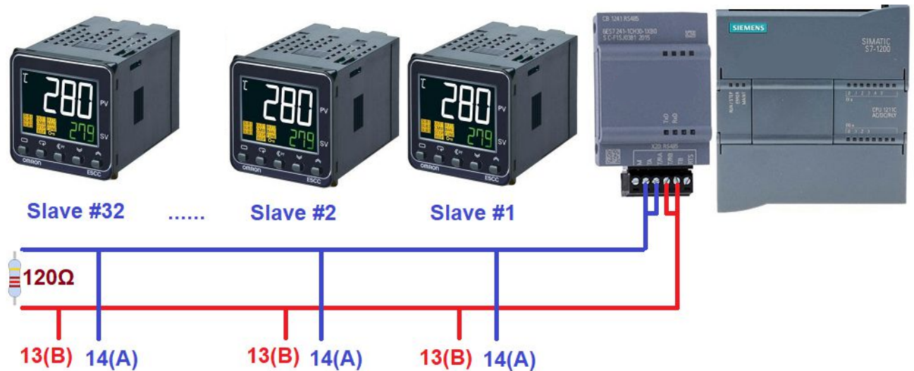
Рис. 1.1. Типова структура мережі Modbus RTU
