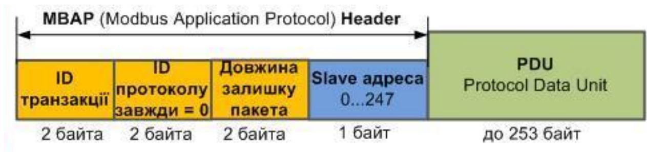
Рис. 1.2. Структура кадру Modbus TCP з MBAP-заголовком
