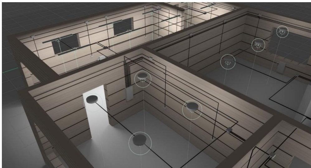
Рисунок 3.8 – Розташування електрощитової з лініями живлення в будинку
