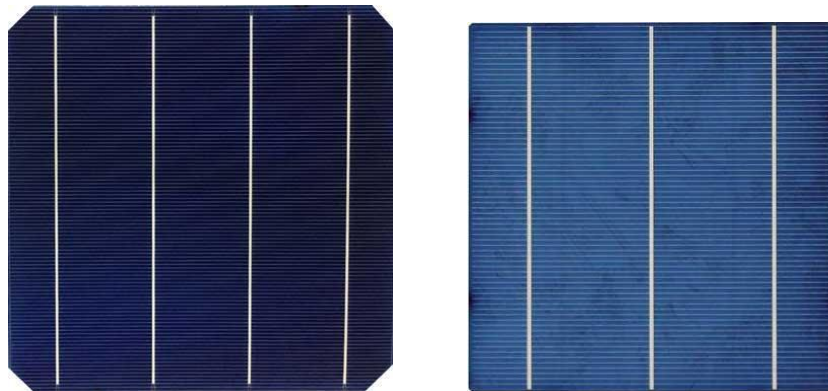
Рисунок 2.1 – Фотоелемент з монокристалічного кремнію (ліворуч) та фотоелемент із полікристалічного кремнію (праворуч)
