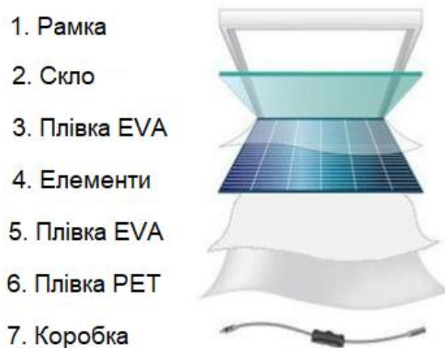
Рисунок 2.2 – Будова сонячної батареї
