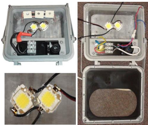
Рисунок 3.11 – Модель інтелектуального світильника потужністю 20 Вт
