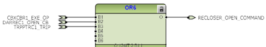
Рис. 3.32 Формування команди на вимкнення і увімкнення реклоузера. Має 3 сигнали. Від АПВ, блоку контролю, захистів
