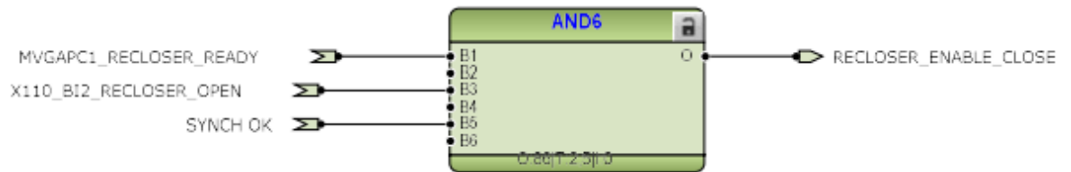
Рис. 3.30 Формування сигналів на блокування увімкнення та на дозвіл увімкнення
