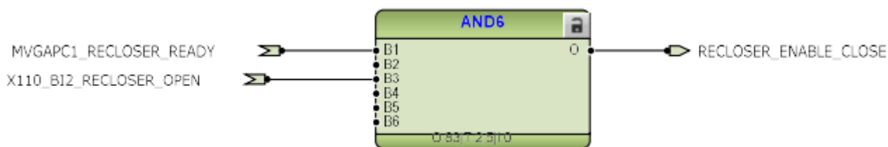
Рис. 3.17 Принцип роботи блоку AND
