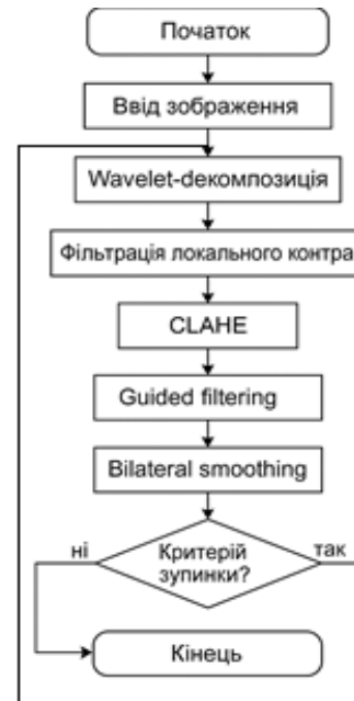
Рис. 4. Блок-схема алгоритму адаптивної компенсації завад
