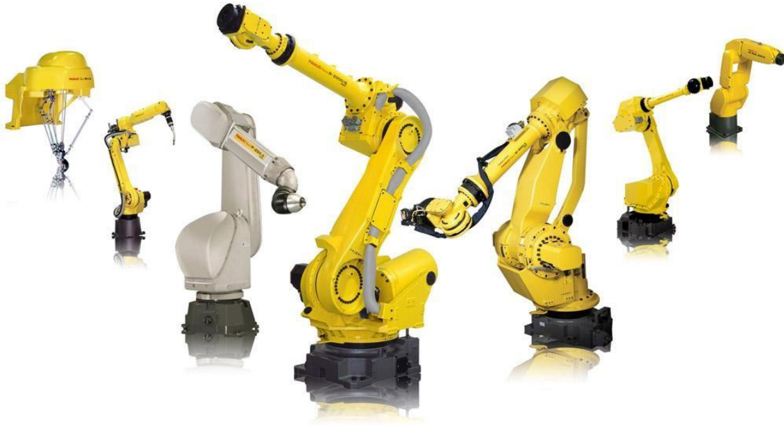
Рисунок 2. Роботи японської компанії FANUC, призначені для зварювання, навантаження, сортування, транспортування та інших точних робіт
