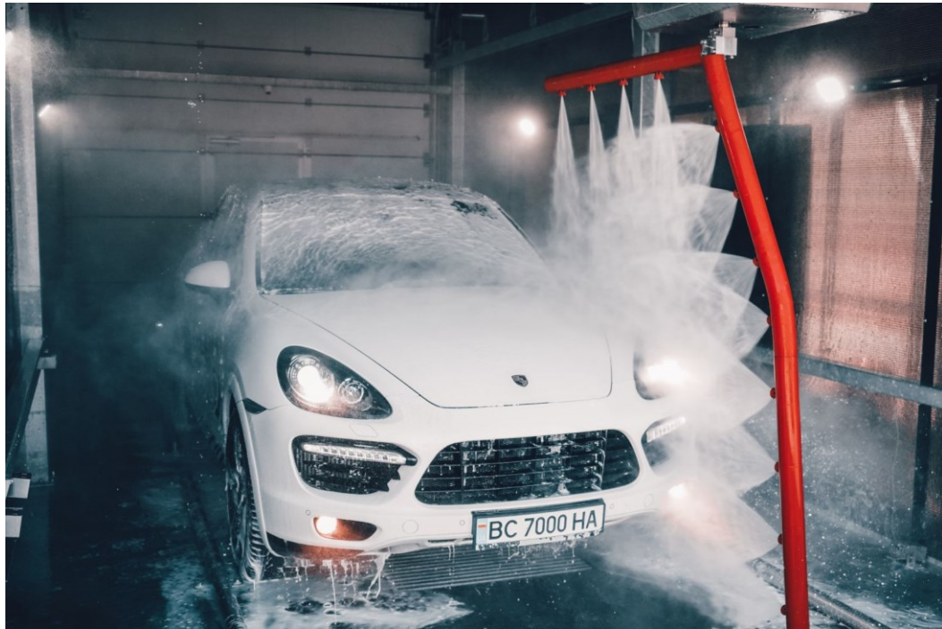
Рисунок 1.2 – Вигляд автоматичної порталної автомийки
