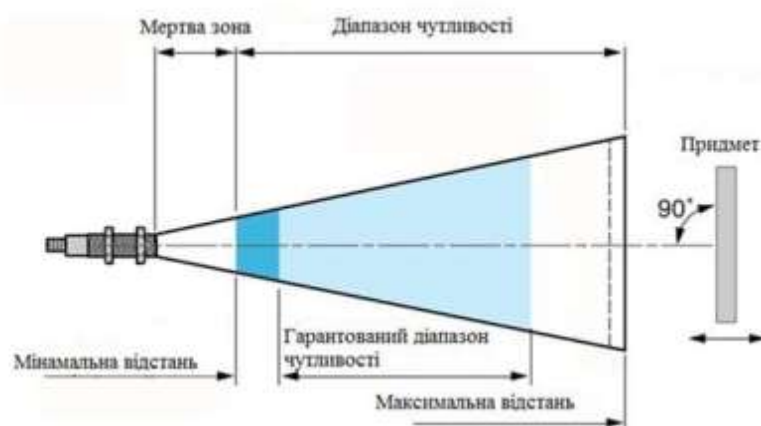
Рисунок 2.4 – Принцип роботи ультразвукового сенсора
