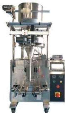
Рисунок 1.2 — Загальна структура системи упаковки “TCLB-160A”
