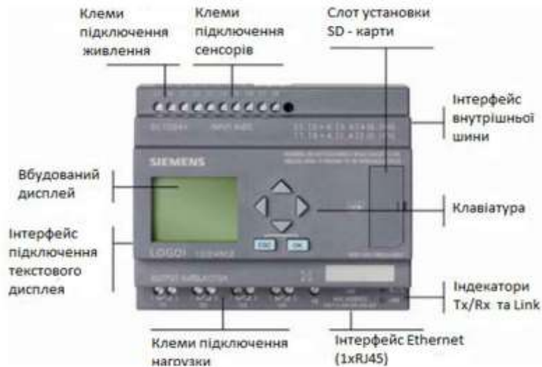
Рисунок 3.1 – Зовнішній вигляд контролера Siemens LOGO! 0BA7
