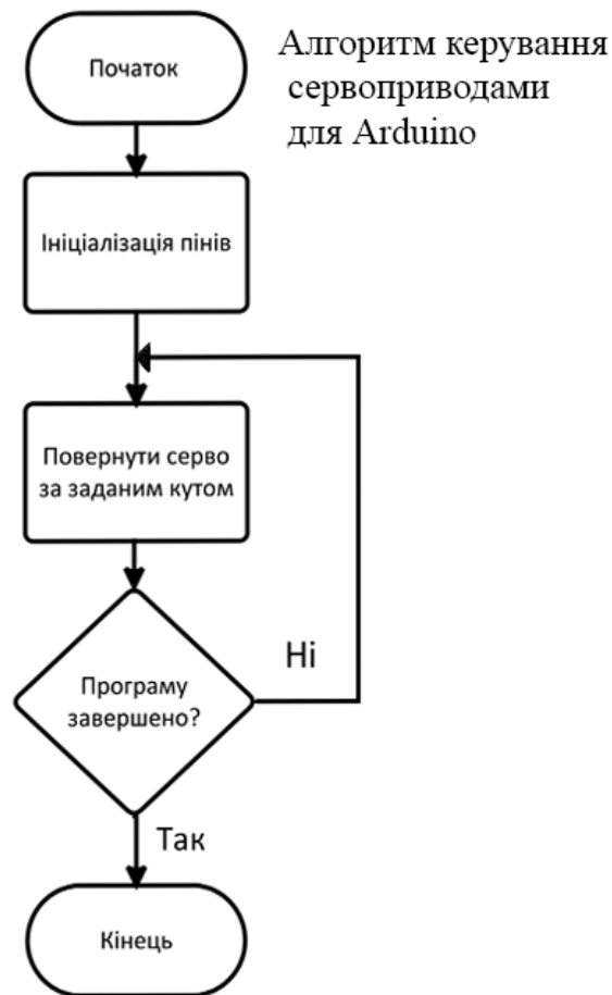
Рисунок 2.10 – Схема алгоритму керування сервоприводів
