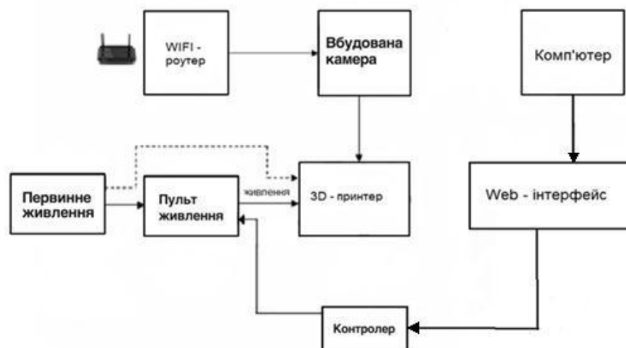
Рисунок 2.1 — Структурна схема комп'ютерної системи
