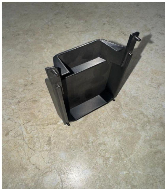
Рисунок 3.2 — Деталь з нависаннями
