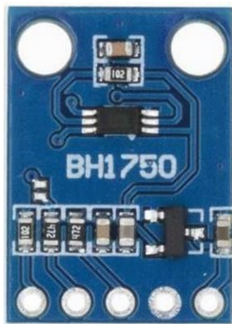
Рисунок 2.9 – Цифровий сенсор BH1750
