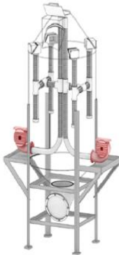
Рисунок 1.2 – Принцип розташування вентиляції у силосах
