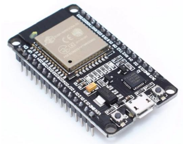
Рисунок 2.2 – Модуль DevKit з ESP-32
