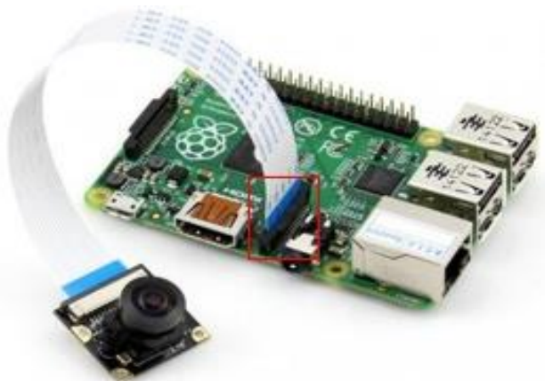
Рисунок 2.4 – Підключення камери до CSI
