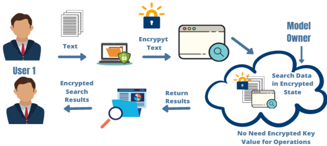
Рисунок 1.5 – Принцип роботи гомоморфного шифрування
