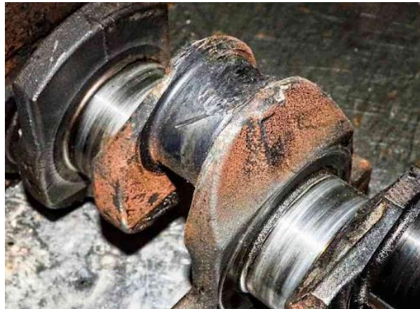
Рисунок 1.7 - Пошкоджена деталь після провертання вкладишів
