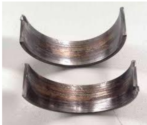
Рисунок 1.6 - Пошкоджені шатунні вкладиші
