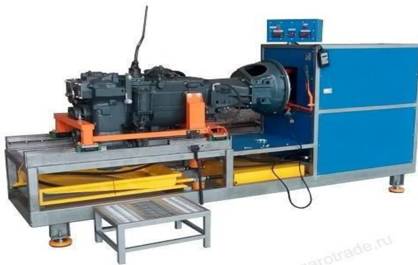
Рис. 3.2. Механізований стенд для обкатки коробок передач легкових автомобілів.
