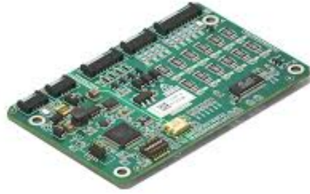
Рисунок 1.10. Система керування батареєю (Battery Management System, BMS)
