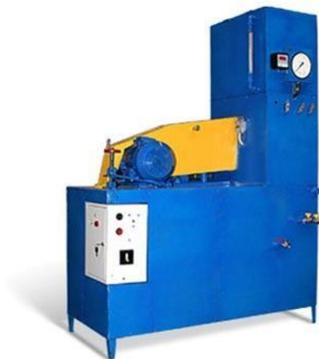
Рис. 3.3. Стенд для контролю та регулювання параметрів масляних насосів типу СПВ-236.
