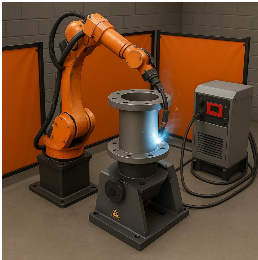
Рис. 3.3 Роботизованный пост сваривания корпуса
