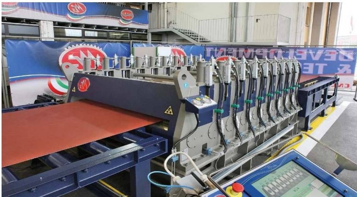
Рис. 2.6 – Машина багатовалкова правильна MGSP2565 [ 18]
