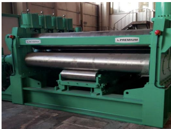
Рис. 2.9 – Машина листоправильна BPSM 20/18 [17]
