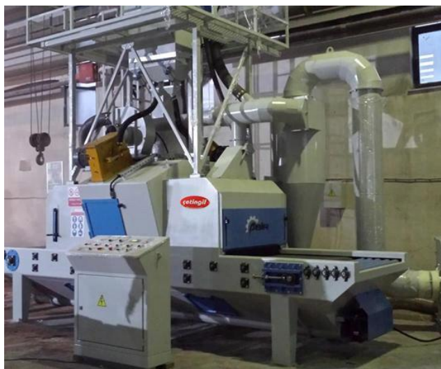
Рис. 2.10 – Установка дробоструминева прохідна SK-1 ÇETİNGİL [17]
