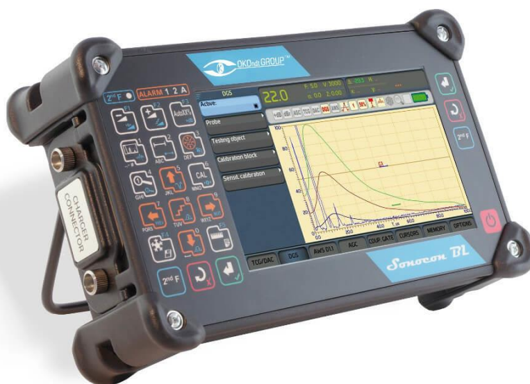
Рис. 2.8 — Портативний ультразвуковий дефектоскоп УД4 – 76[16].
