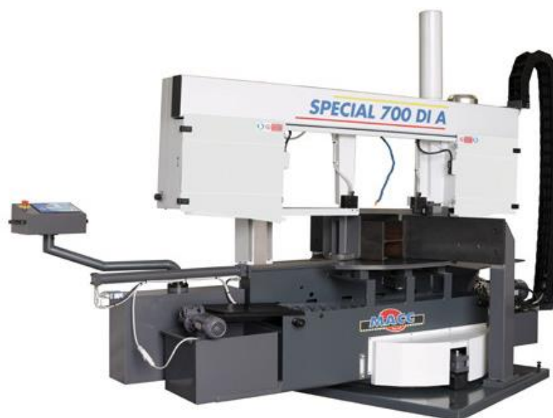
Рис. 2.12 – Профільно-відрізний станок SPECIAL700DI-АМАСС [17]
