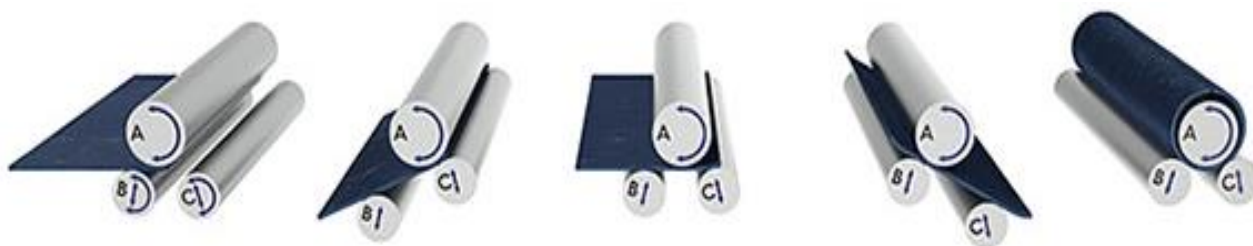
Рис. 2.12. — Хема вальцювання основної частини ресивера [19]
