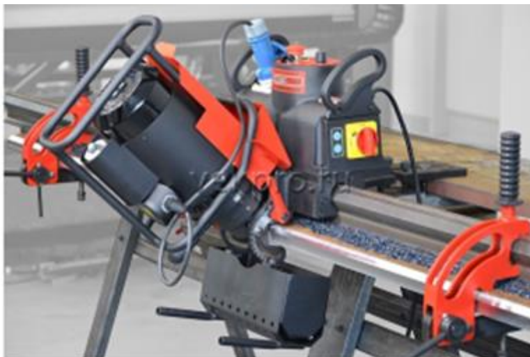
Рис. 2.8 – Кромкостругальний станок АВМ28 [21]
