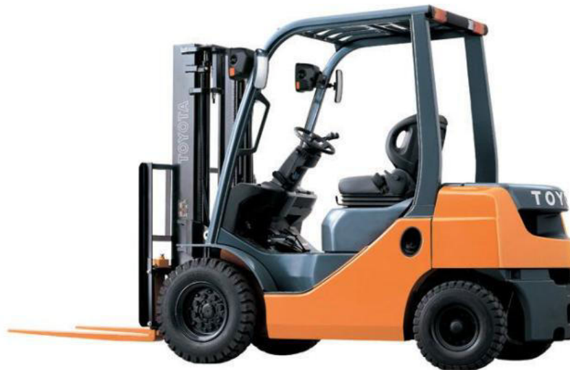
Рисунок 2.6. Дизельний вилковий навантажувач Toyota 8FD18/15
