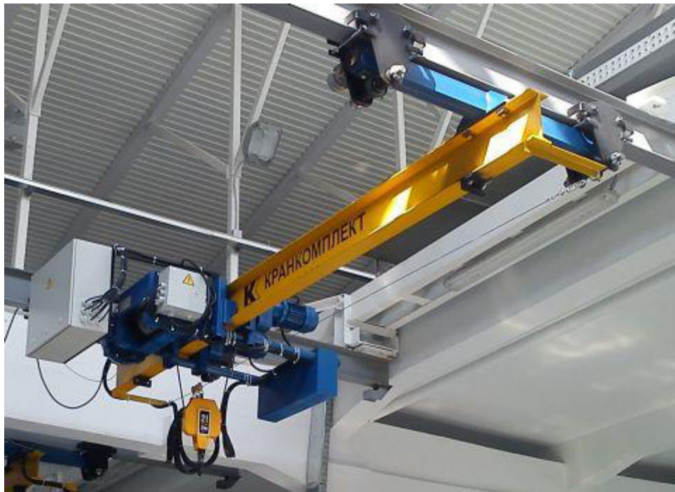
Рисунок 2.2. Кран-балка вантажопідйомністю 3 т.
