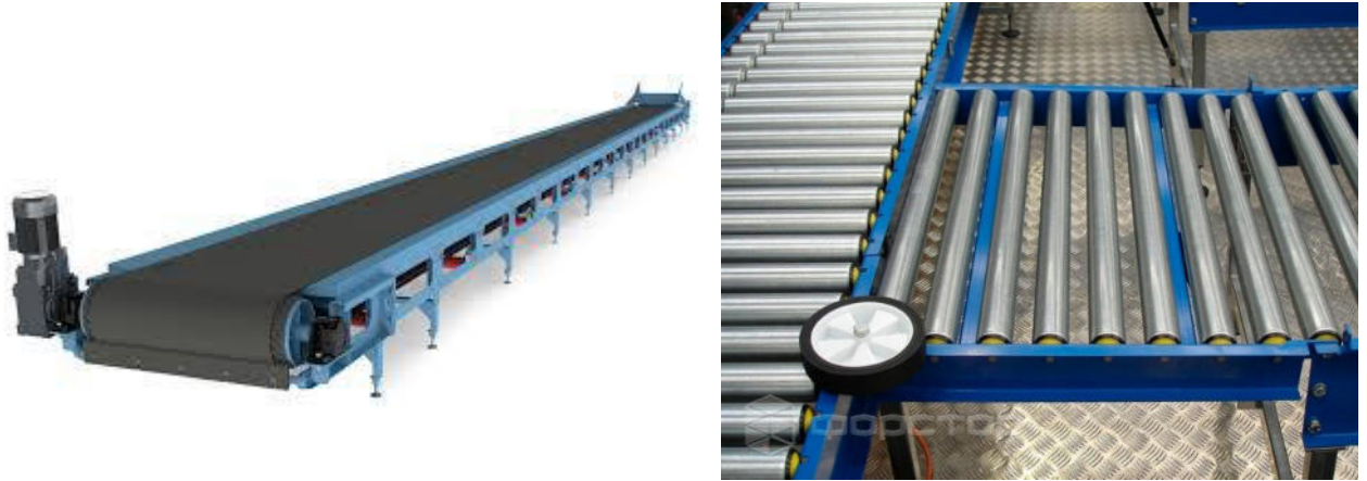
Рисунок 2.3. Стрічковий та роликовий конвеєр для переміщення пакетованих вантажів
