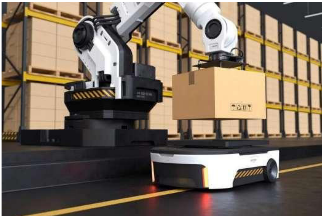
Рисунок 2.4 Роботизована платформа AMR, що взаємодіє із завантажувачем
