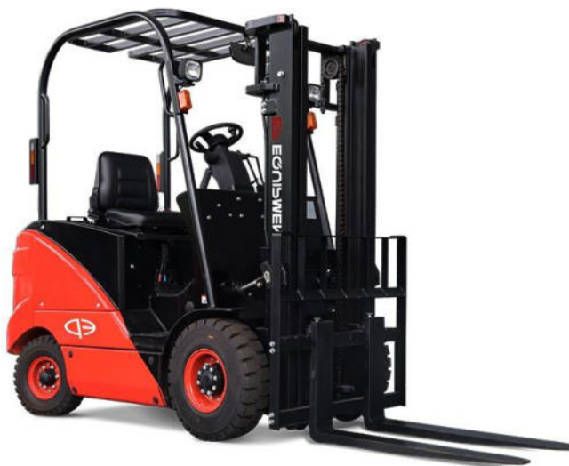
Рисунок 2.1 Електричний вилковий навантажувач ЕР
