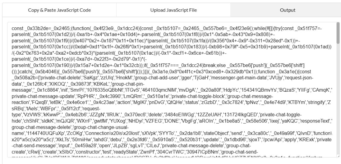
Рисунок 3.6 – Застосування Obfuscator.io для заплутування коду live-чату
