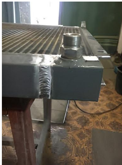
Рисунок 1.7 Ремонт алюмінієвих радіаторів автомобіля зварюванням
