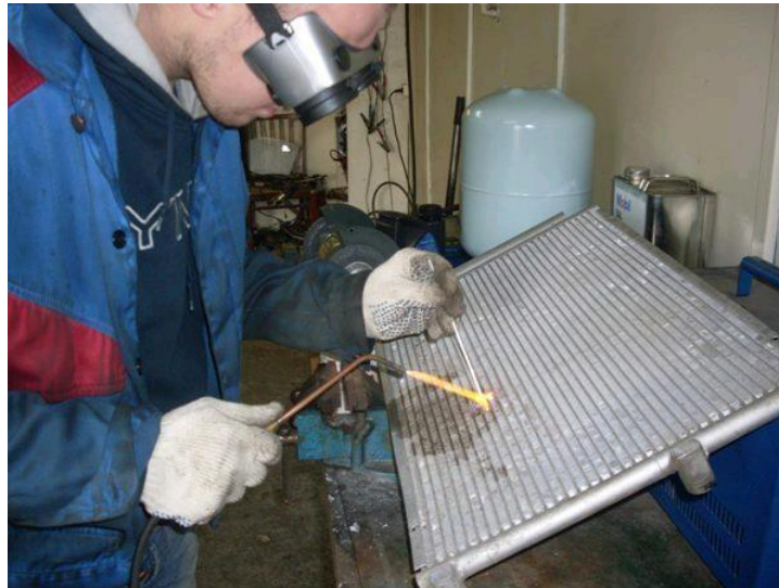
Рисунок 1.9 - Ремонт радіатора автомобіля за допомогою процесу паяння
