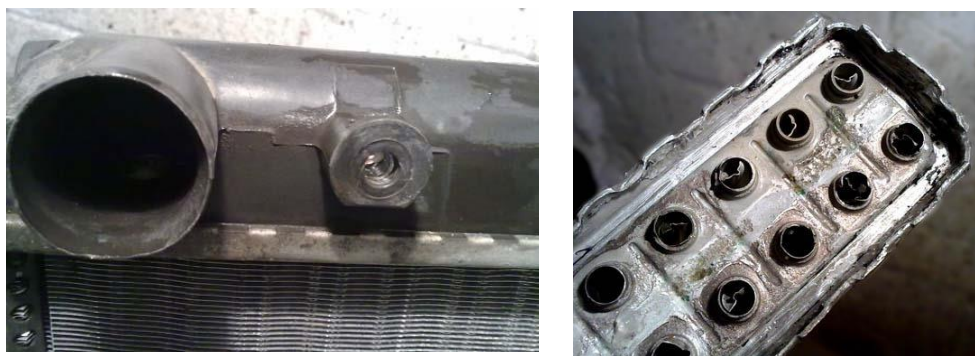
Рисунок 1.2 – Елементи набірного радіатора автомобіля
