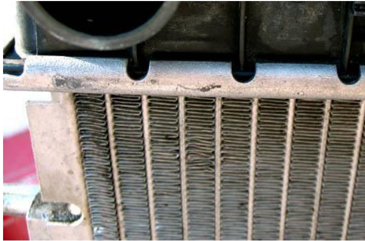
Рисунок 1.4 Загальний вигляд радіатора з цільнопаяною серцевиною і пластмасовими бачками
