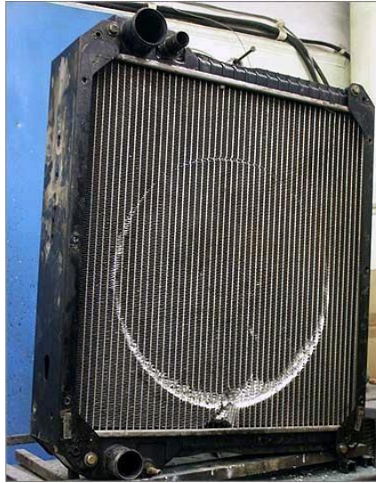
Рисунок 1.5 Характер пошкодження радіатора автомобіля внаслідок ударної дії крильчатки вентилятора
