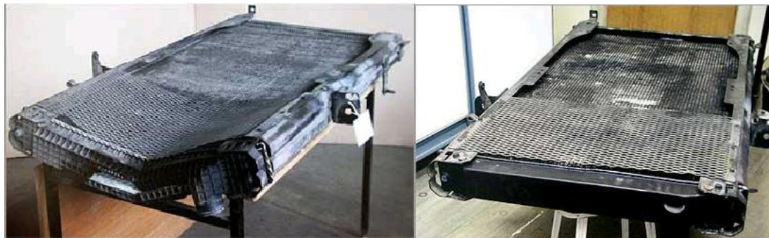
Рисунок 1.6 Загальний вигляд радіатора після аварії (а) та відновленого радіатора (б)
