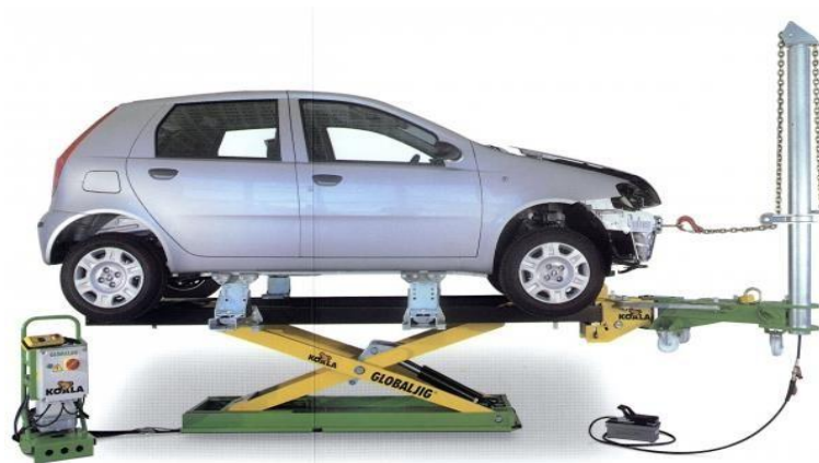
Рисунок 3.1. Стенд для правки кузова автомобіля GLOBALJIG OALA
